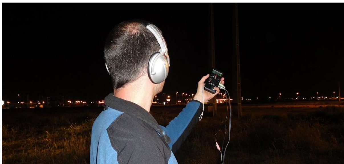
Figura 2 – Técnico em trabalho de campo recorrendo ao detetor de ultrassons Pettersson Elektronik AB Mod. D 240 para detetar morcegos (Foto: Strix).
